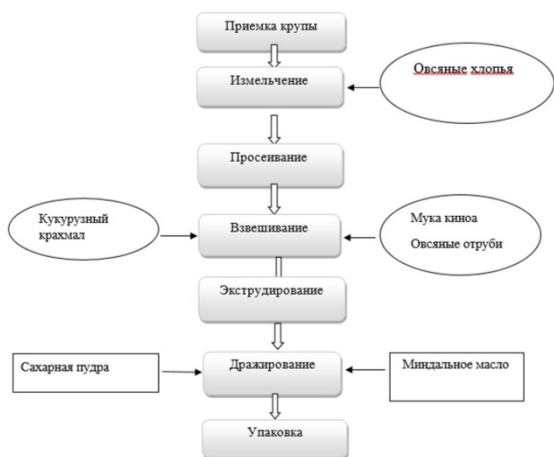
Рис. 1. Векторная схема получения экструдированных палочек Fig. 1. Vector diagram for obtaining extruded sticks
