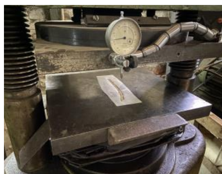
Рис. 2. Плущение жилки на прессе
