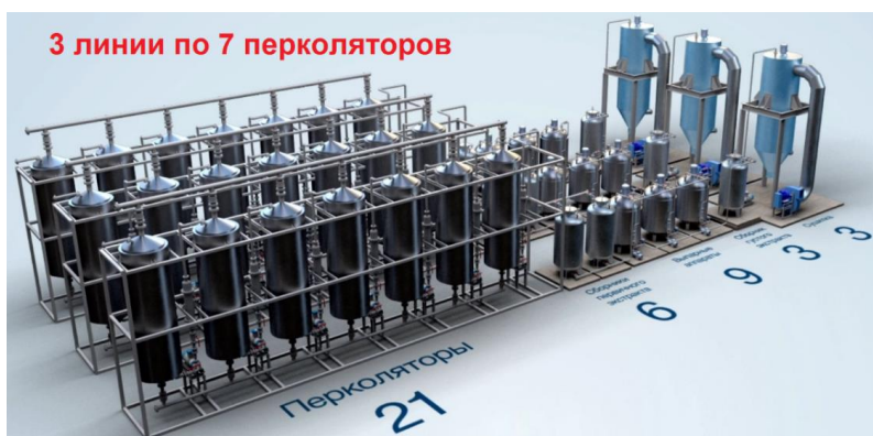
Рис. 5. Традиционная линия получения растворимого порошка цикория производительностью 390 кг/ч по исходному обжаренному цикорию
