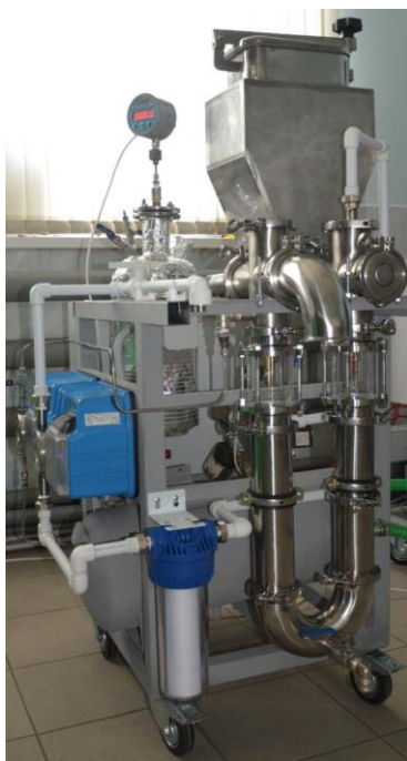
Рис. 3. Пилотная пульсационная установка (ППУ) для экстрагирования
