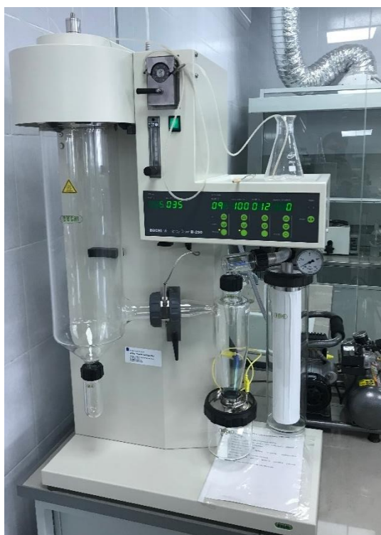
Рис. 3. Лабораторная установка распылительной сушилки модели Mini Spray Dryer B-290
