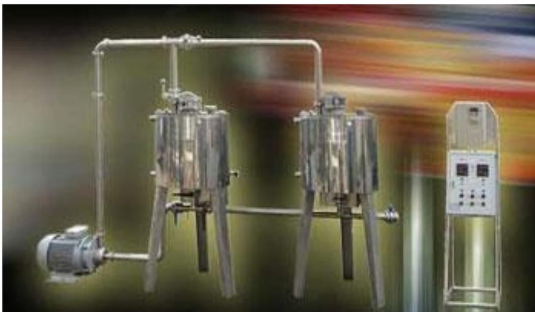
*Рис. 2. Установка гидродинамической экстракции*
