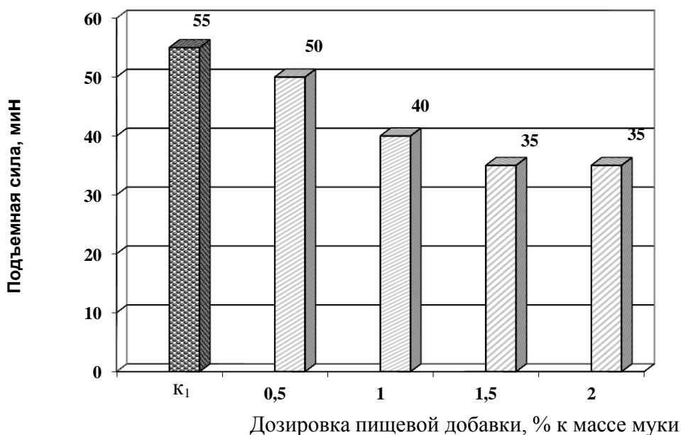
Рис. 1. Эффективность влияния пищевой добавки «Порошок грушевый» на подъемную силу хлебопекарных прессованных дрожжей: k_1 – контроль (подъемная сила – 55 мин.)
