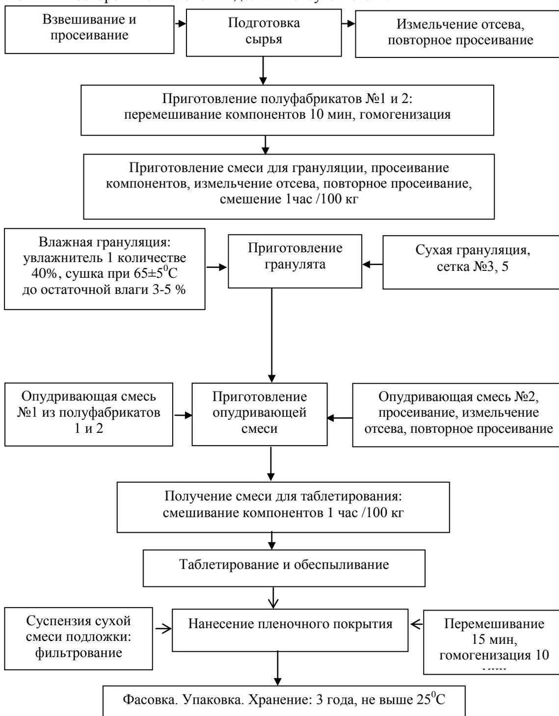
Рис. 1. Технологическая схема производства БАД «София»
