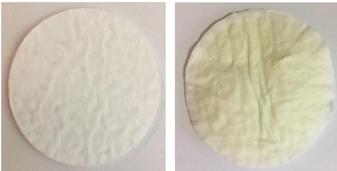
Рис. 1. Кембриджский фильтр до и после прокуривания опытного образца кальянной смеси на курительной машине Cerulean SM405
