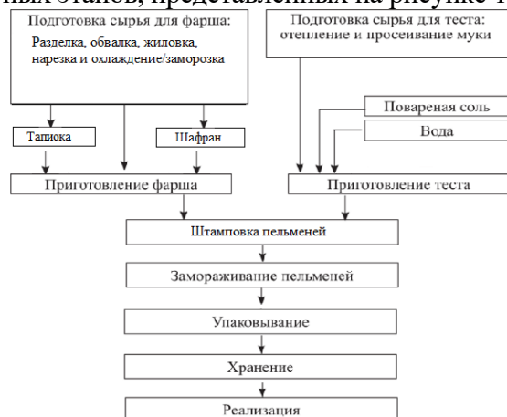
Рис. 1. Технологическая схема производства пельменей
