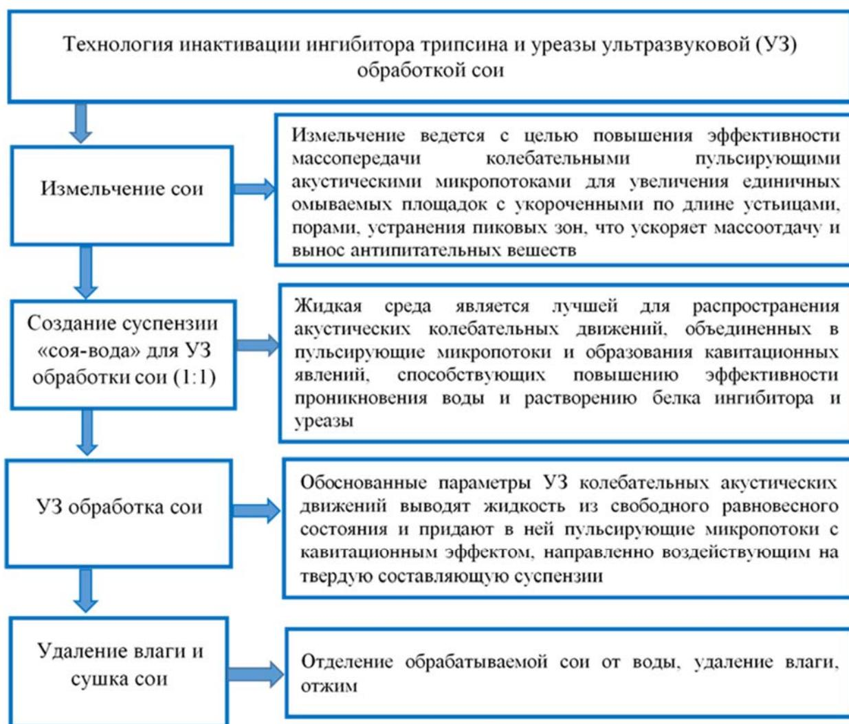
**Рис. 1.** Технологическая схема обработки сои
