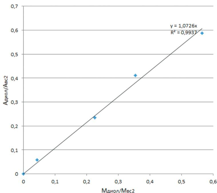
Рис. 4. Калибровочная кривая для количественного расчета диацилглицеринов
