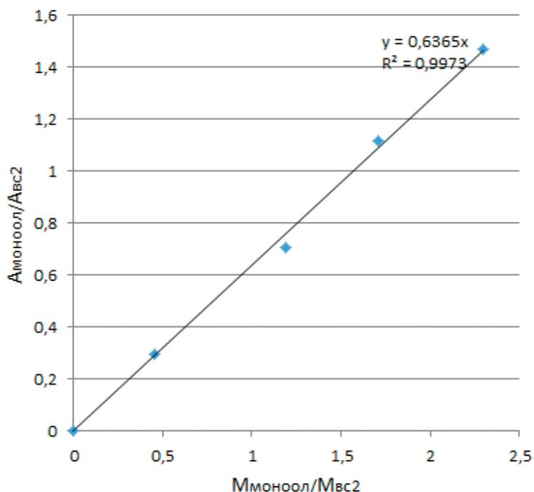
Рис. 3. Калибровочная кривая для количественного расчета моноацилглицеринов
