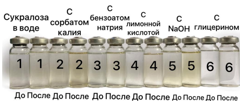
Рис. 2. Внешний вид флаконов до и после 30 дней термостат 45 с раствором 15% сукралозы в воде (1), (2) – с добавлением 0,1% сорбата калия, (3) – 0,1% бензоата натрия, (4) лимонной кислоты до pH = 3,5, (5) 0,1 M NaOH до pH 8,8; (6) раствор 15% сукралозы в смеси глицерин/вода 84/16.
