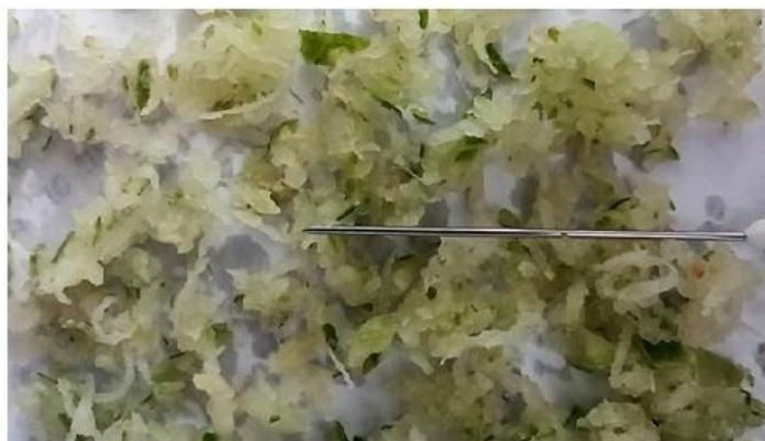
Рис. 4. Фотоснимок диспергированных фрагментов частиц арбузной корки
