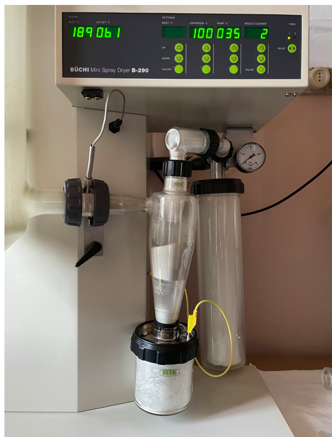
Рис. 2. Сушка белкового препарата из семян подсолнечника
