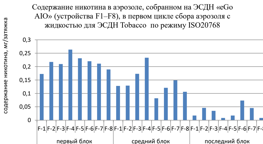
Рис. 7. Содержание никотина в твердожидкой фазе аэрозоля, собранном на ЭСДН «eGo AIO» (устройства F1–F8), в первом цикле сбора аэрозоля с жидкостью для ЭСДН Tobacco по режиму ISO 20768
